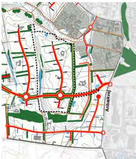
Udsnittet af strukturplanen viser hvordan fordelingsvejen, der går gennem lokalplanområdet, forbindes til Anbækvej med en rundkørsel ved Frankrigsvej.
